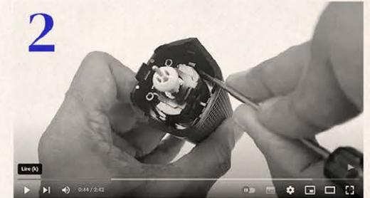
Une fois la deuxième coque retirée, il est nécessaire de se munir d'un tournevis pour cette étape. Insérez doucement la tête plate au dessus de chaque petits taquets latéraux et déclipsez-les un à un jusqu'à la libération du coeur de la tondeuse de son corps.
